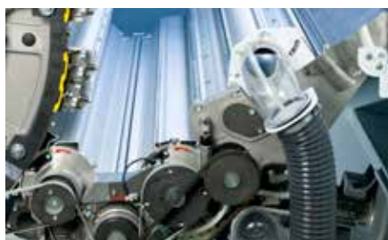
SENSOFEED+: 一体化感应喂棉装置, 完美的握持, 精确的短片段自调匀整 第 8 页
