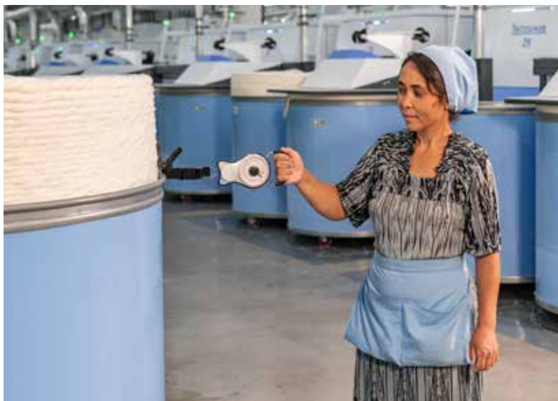
JUMBO CAN大尺寸条筒中可填充79kg棉条。通过悬挂秤数据来看，移动条筒所需的作用力在6-8kg左右。
