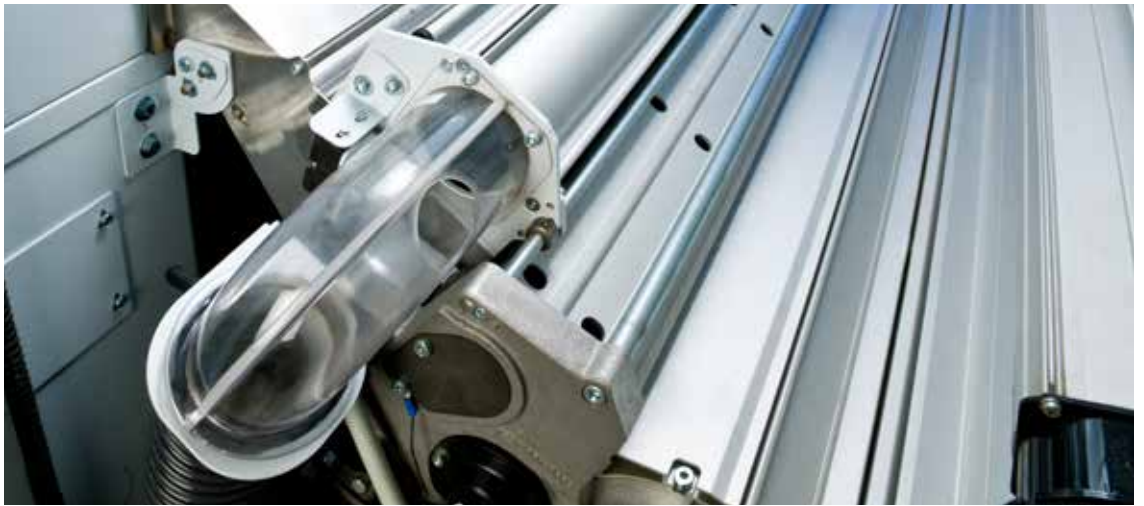
图为直接喂棉箱 DIRECTFEED与梳 棉机之间的为不 锈钢通道
