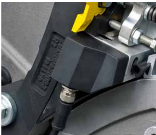
无需接触，传感器也可以检测锡林温度
