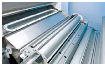
DIRECTEDFEED: 完全一体化的棉簇喂棉装置, 内置了空气分离器以及分段式喂棉板 第 8 页
