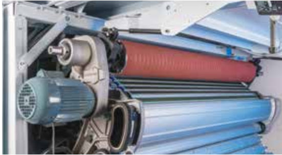
机上磨盖板装置TC-FG能够快速简便地打磨活动盖板针布
