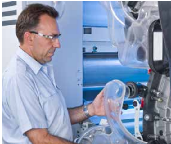
通过快速更换系统对吸风管道进行安装和拆卸, 无需任何工具。
