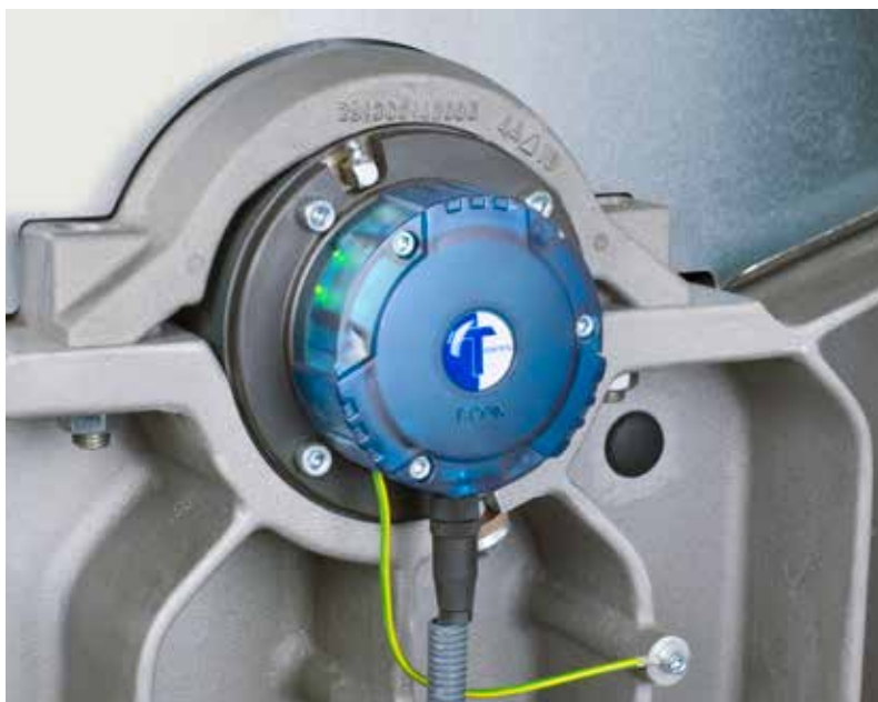
传感器可测定梳理元件之间的接触情况
